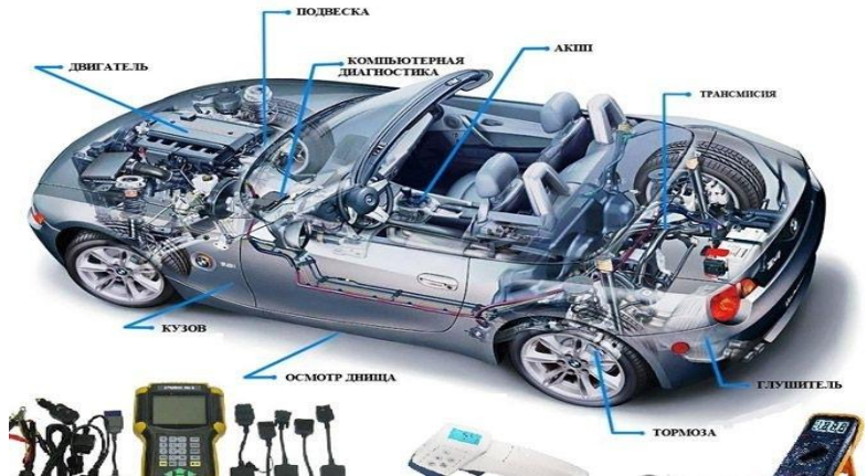
Рисунок 6 – Основные элементы диагностики автомобиля
