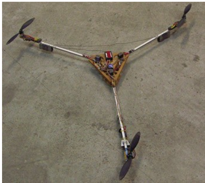
Рис. 1.2.2. Трикоптер. Один из первых мультикоптеров.
